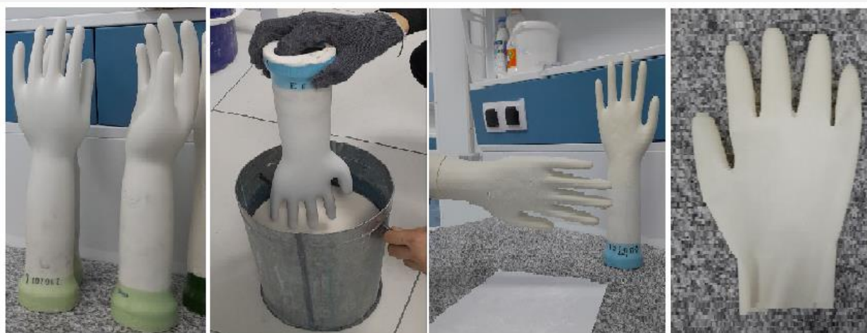
Рисунок 3. Процесс получения медицинских перчаток на основе модифицированного натурального каучука (латекса).
