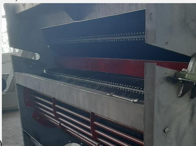
2-расм. Чўткали ажратувчи барабанни жойлаштириш схемаси (а) ва қия бурчакда тайёрланган жойининг фото лавҳаси (б).
