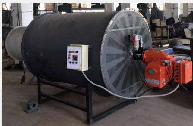
1-рисунок Общий вид нового теплогенератора
